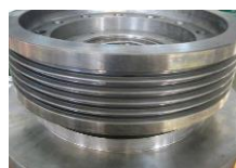
图 47 曳引轮套入转子
